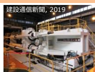
80MN級試験機などを使用した破壊試験
