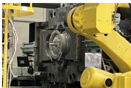
1650tダイカストマシンでの成形試験
