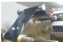
ロールtoロールでの生産
