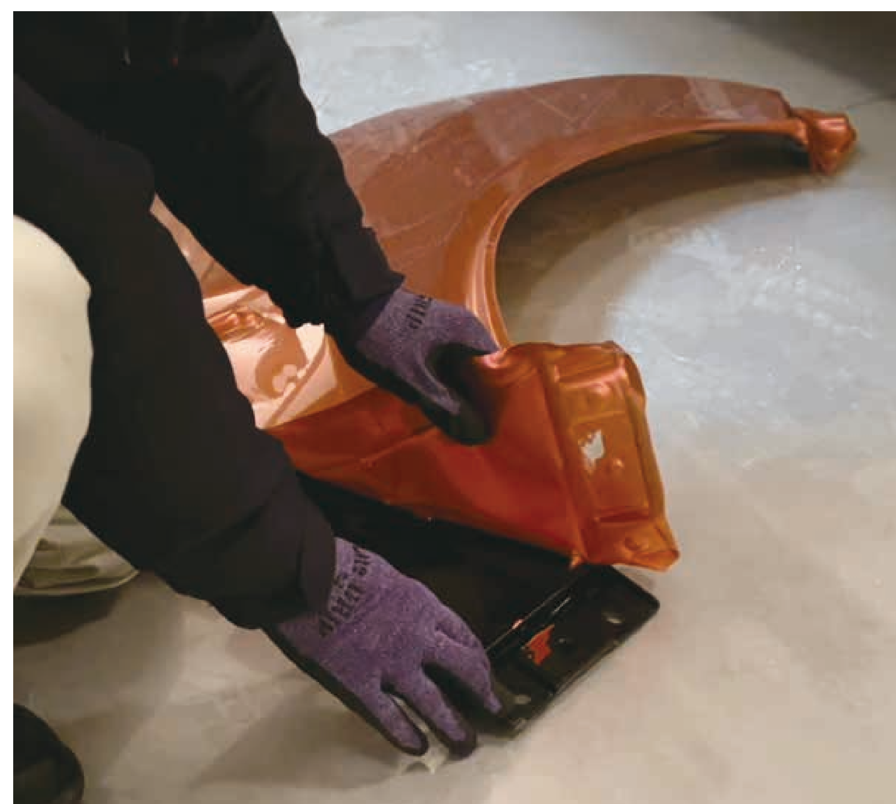
冷却による剥離試験
