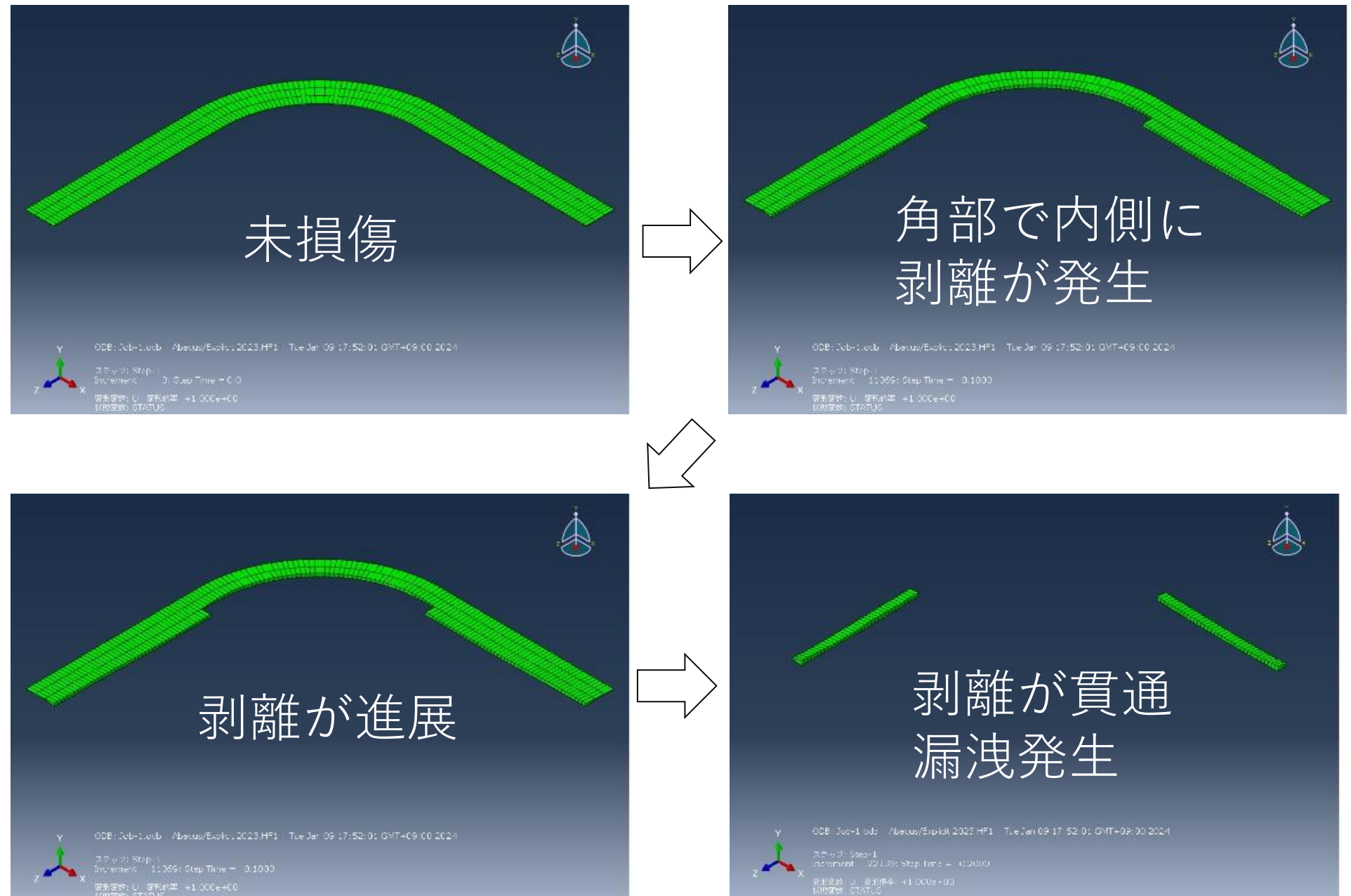
接着剤層の剥離進展挙動
