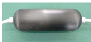
速硬化プリプレグで成形した 小型タンク（φ100, L=500）の写真
