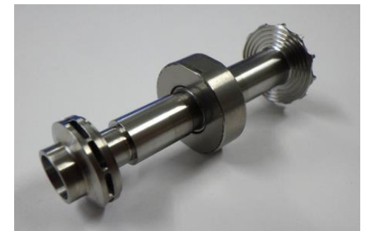
試作水素タービン インペラー径： \phi 18 mm 全長：66 mm
