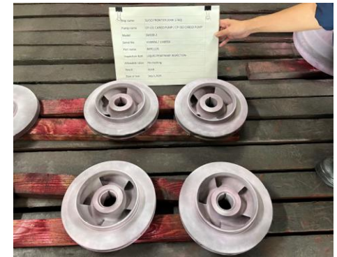
カーゴポンプ インペラ浸透探傷試験時
