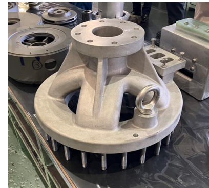
カーゴポンプ 吐出マニフォールド
