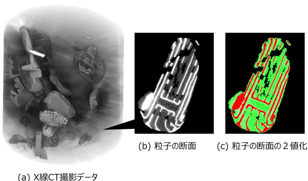
図 4-101 X線CTによる2次元及び3次元の単体分離情報分析
