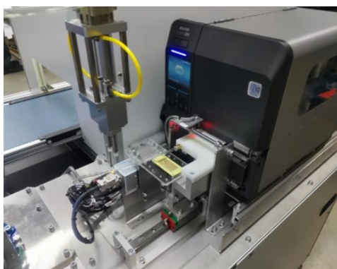
図 4-108 RFID タグ自動貼付システム(試作機)の外観
