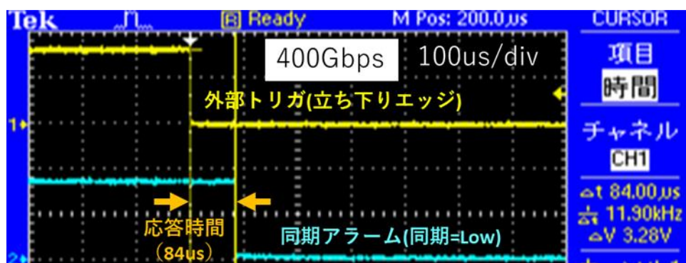
図 1.5.4.16 最終試作チップによる応答時間測定結果 (400Gbps)
