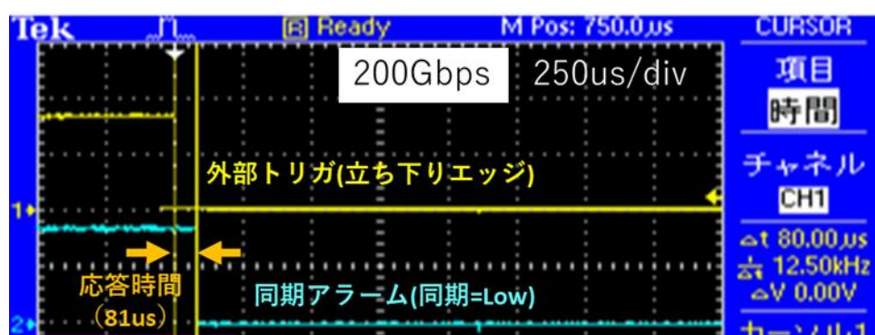
図 1.5.4.15 最終試作チップによる応答時間測定結果 (200Gbps)
