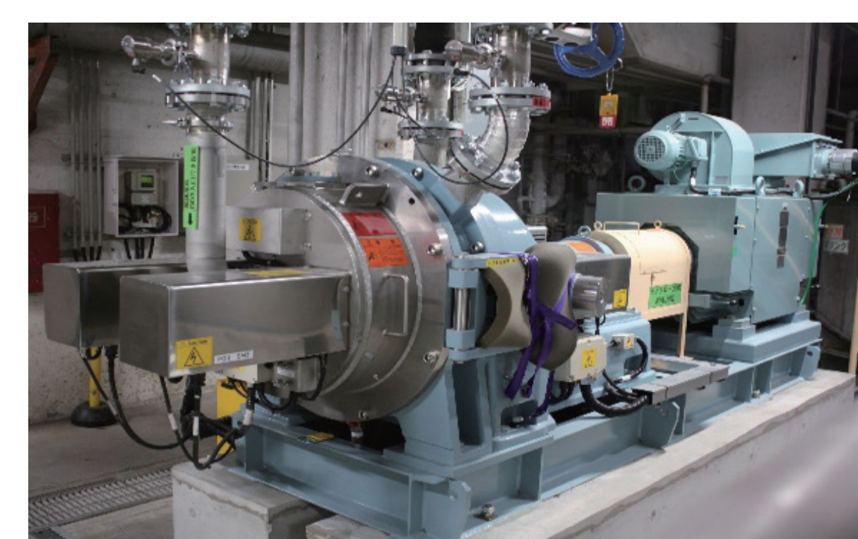
図1 新規解繊機(左:ノズル型 右:ディスク型)
