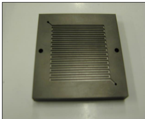
JARI標準セルのガス流路
