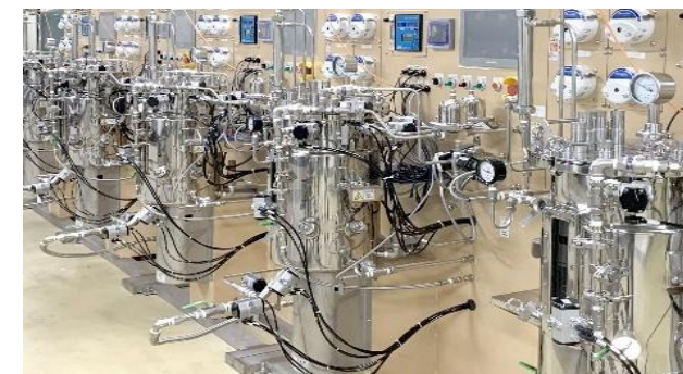
30L培養設備10基（5基×2社製品）
