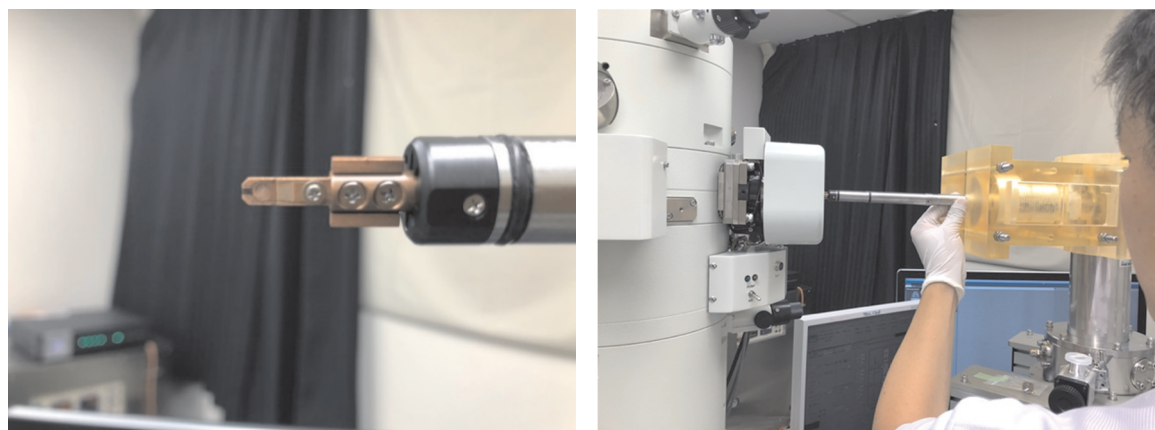
図2. 2. 1-1 九州工業大学が開発したクライオ電子顕微鏡用共通資料ホルダ(左)と挿入作業の様子(右)。先端部には「マイクロホルダ(電子顕微鏡用グリッド等)」が装着可能な構造になっている。詳細は九州工業大学の報告項を参照のこと。
